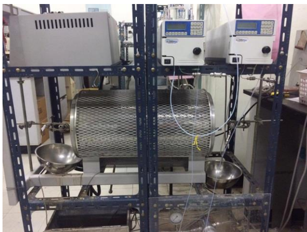
รูปที่ 3.2 เครื่องปฏิกรณ์แบบกึ่งต่อเนื่อง
