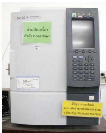
รูปที่ 3.8 เครื่องแก๊สโครมาโทกราฟี (gas chromatograph)
