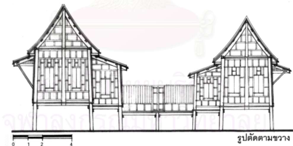
ภาพที่ 4.1.8 : รูปตัดแสดงองค์ประกอบทางสถาปัตยกรรม และโครงสร้าง ของหมู่ภูมิคณะ 6 วัดชนะสงคราม (จากการสำรวจของผู้วิจัย ตุลาคม 2543)
