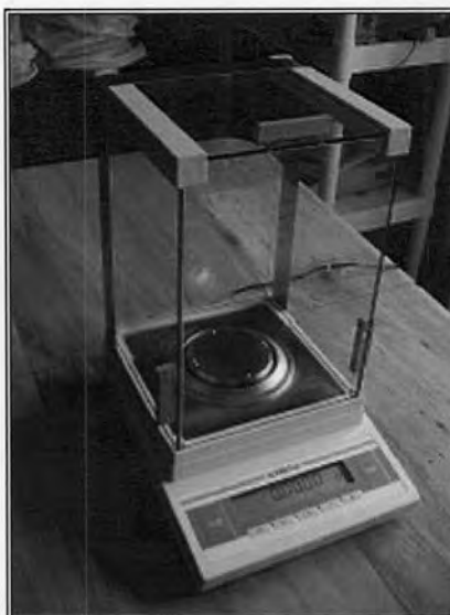
รูปที่ 28 แสดงเครื่องชั่งน้ำหนักไฟฟ้า ทศนิยม 4 ตำแหน่ง
