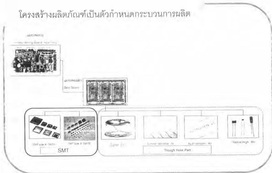
ภาพที่ 1.2 โครงสร้างผลิตภัณฑ์แผงวงจรโดยแบ่งตามสถานีของเครื่องจักรที่ใช้ในการผลิต
