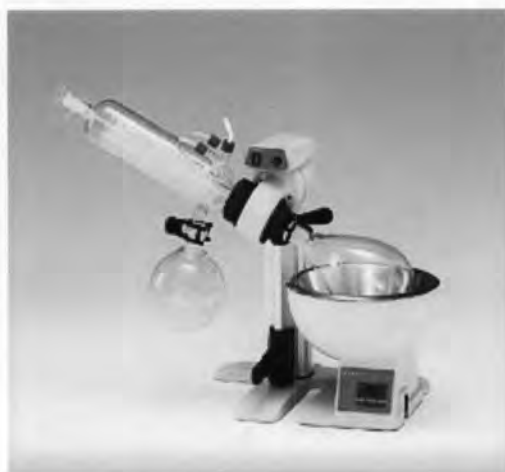
รูปที่ 3.2 การจัดตั้งอุปกรณ์สำหรับการระเหยแห้งด้วยเครื่องระเหยแห้งสุญญากาศ
