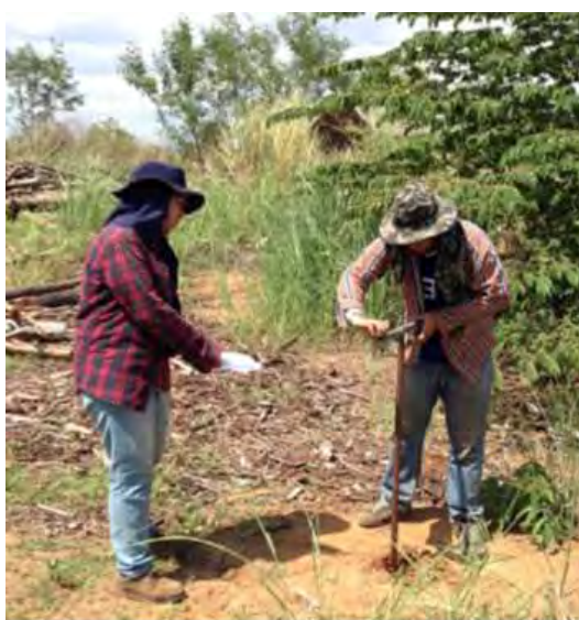
รูปที่ 3.5 แสดงการเก็บตัวอย่างตะกอนดินบริเวณที่ราบด้านตะวันออก โดยใช้ Soil auger
