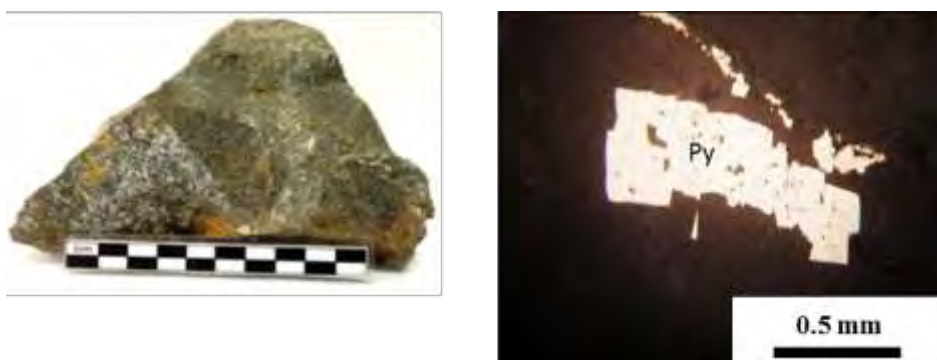
รูปที่ 4.4 ตัวอย่างหินและภาพถ่ายภายใต้กล้องจุลทรรศน์สะท้อนแสง ของ KP-5 Py=Pyrite ผลึกไพไรต์ (Pyrite) ขนาดปานกลาง แสดงลักษณะหน้าผลึกชัดเจน (Euhedral crystals)
