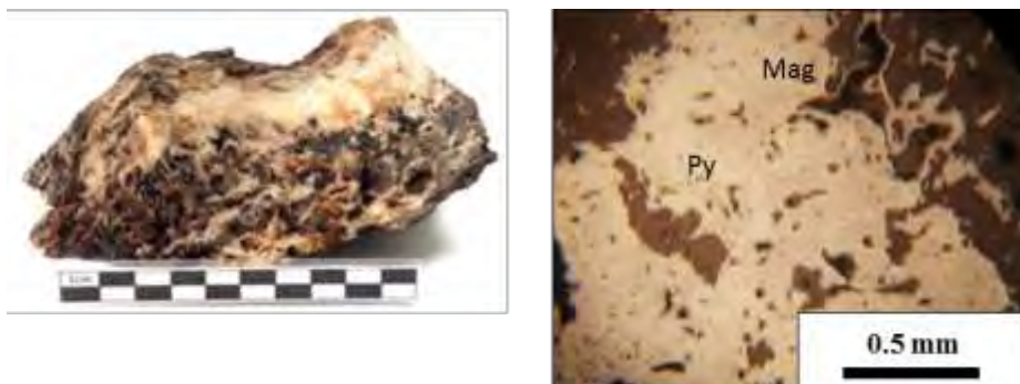
รูปที่ 4.2 ตัวอย่างหินและภาพถ่ายภายใต้กล้องจุลทรรศน์สะท้อนแสง ของ KP-1 Mag=Magnetite Py=Pyrite ผลึกไพไรต์ (Pyrite) มีขนาดใหญ่ ไม่ปรากฏลักษณะของหน้าผลึก (Anhedral crystals) บางส่วนถูกออกซิไดซ์เกิดเป็นแมกมาไทต์ (Magmatite) (สีเข้มกว่า)
