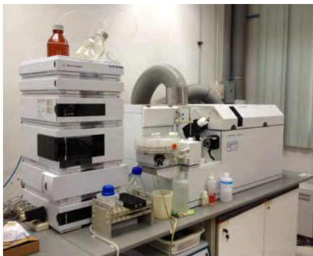
รูปที่ 3.12 เครื่อง ICP-MS ยี่ห้อ Agilent Technologies รุ่น 7500 series
