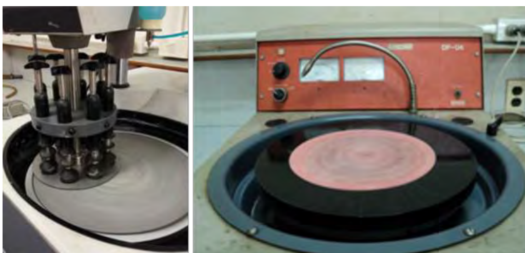
รูปที่ 3.7 เครื่องขัดตัวอย่างชิ้นงาน 6 และ 3 ไมครอน จากซ้ายไปขวา
