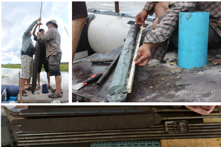
รูปที่ 3 เครื่องเก็บแท่งตะกอนแบบรัสเซีย (russian corer) (รูปล่าง) และการเก็บตัวอย่างแท่ง ตะกอนที่ทะเลน้อย
