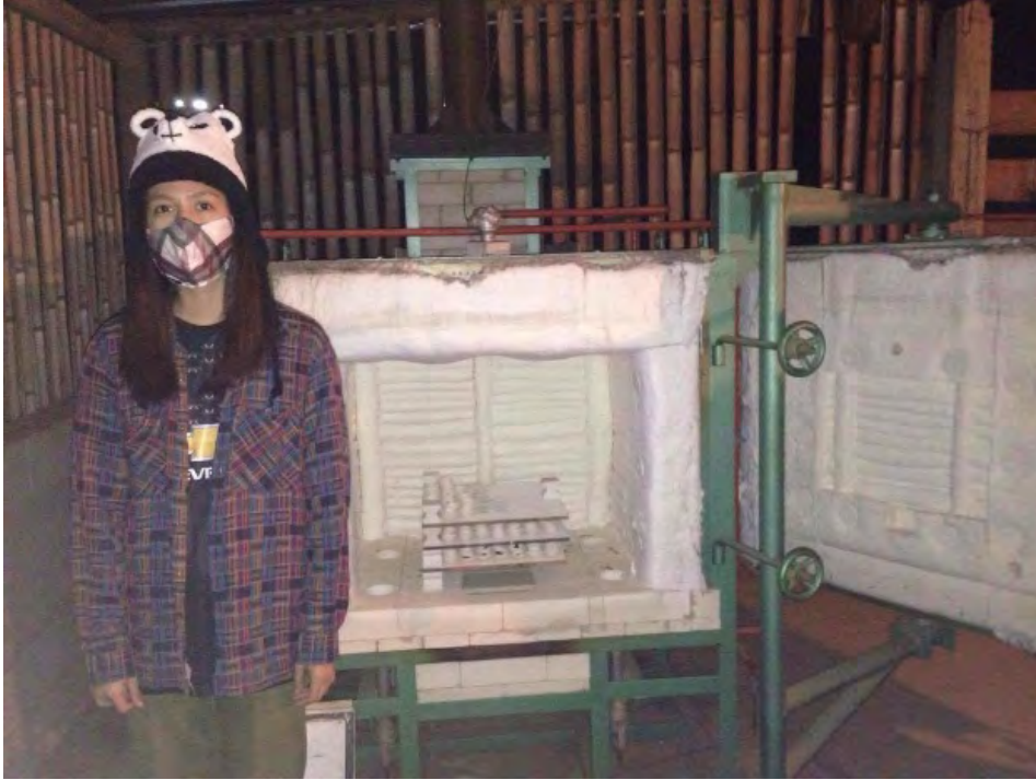
รูปที่ 6 เตาเผาเซรามิกอุณหภูมิสูงที่ใช้ในการวิเคราะห์มวลที่หายไปจากการเผาที่อุณหภูมิ 550 องศาเซลเซียส (คนในรูปสูง 175 ซม.)
