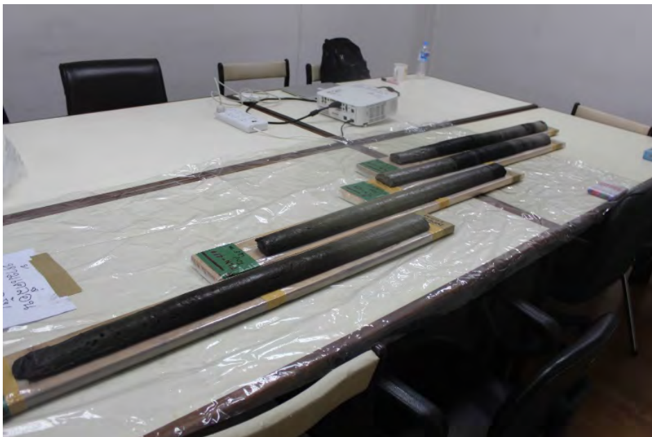
รูปที่ 5 การเทียบความลึกกร่วมของแท่งตะกอน เพื่อวิเคราะห์และทำลำดับชั้นตะกอนออกมาให้มีความต่อเนื่องกัน
