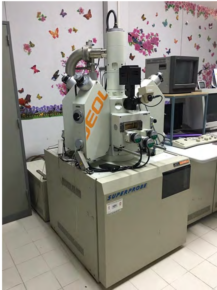
รูปที่ 1.10 เครื่อง EPMA ยี่ห้อ JOEL รุ่น JXA-8100 สำหรับวิเคราะห์ธาตุร่องรอย
