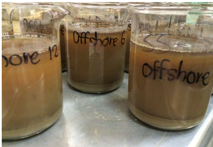
รูปที่ 2.7 บีกเกอร์ส่วนผสมระหว่างตะกอนตัวอย่างกับสาร Calgon และน้ำกลั่น หลังจากปล่อยให้ทิ้งไว้ 2 ชั่วโมง องค์ประกอบส่วนที่ไม่ใช่แร่ดินได้ตกตะกอนสู่ก้นบีกเกอร์
