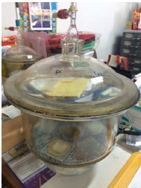
รูปที่ 2.9 กระจกสไลด์ที่เตรียมด้วยวิธี Glycolated จัดเรียงใน Desiccators ที่มีสาร Ethylene glycol เป็นเวลา 12 ชั่วโมง
