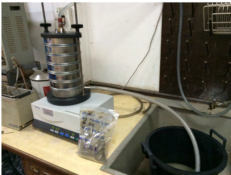
รูปที่ 2.5 การร่อนคัดขนาดเม็ดตะกอนแบบใช้น้ำ (Wet sieving)
