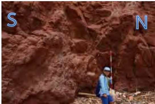
รูปที่ 4.6 แสดงค่าโครงสร้างไม่ต่อเนื่อง(รอยแตก ระบบรอยแตก รอยเลื่อน)และลักษณะการกัดเซาะที่แสดงลักษณะเป็นสัน
