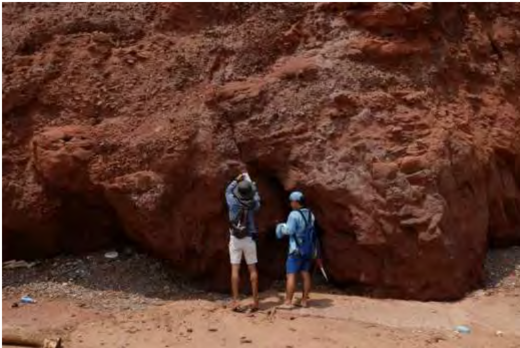
รูปที่ 3.6 แสดงเก็บข้อมูลลักษณะโครงสร้างทางธรณีวิทยาความไม่ต่อเนื่องของชั้นหิน
