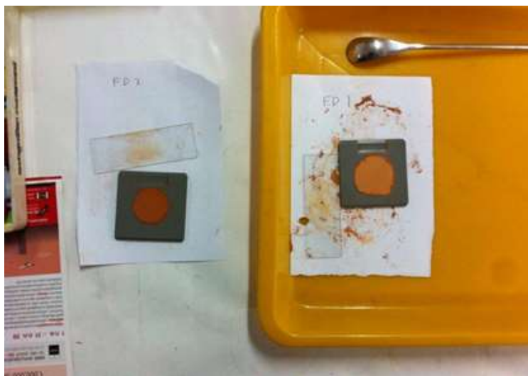
รูปที่ 3.10 แสดงการเตรียมตัวอย่างผงสำหรับการตรวจสอบด้วยเครื่อง XRD
