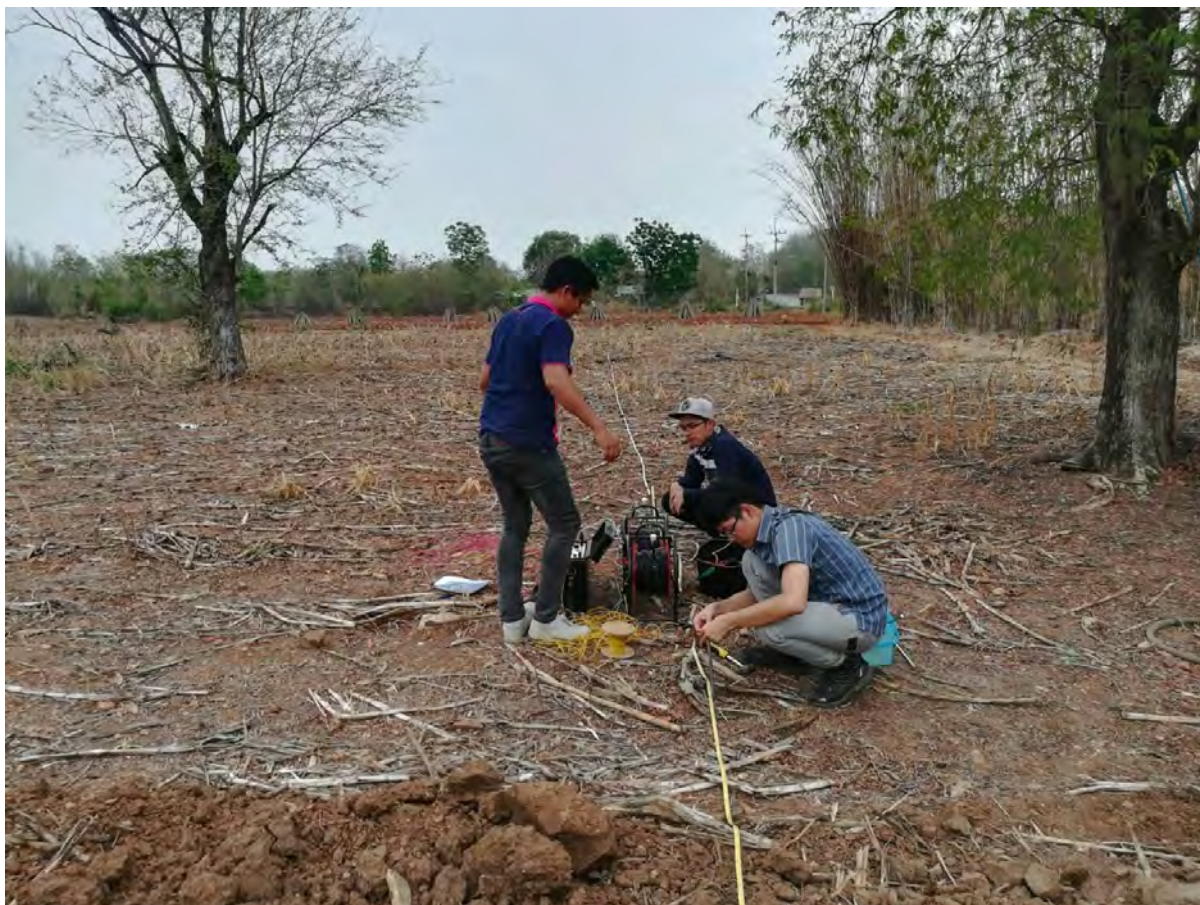
รูปที่ 4.13 ภาพการสำรวจธรณีฟิสิกส์ด้วยวิธีการวัดค่าความต้านทานไฟฟ้าจุดที่ 3
