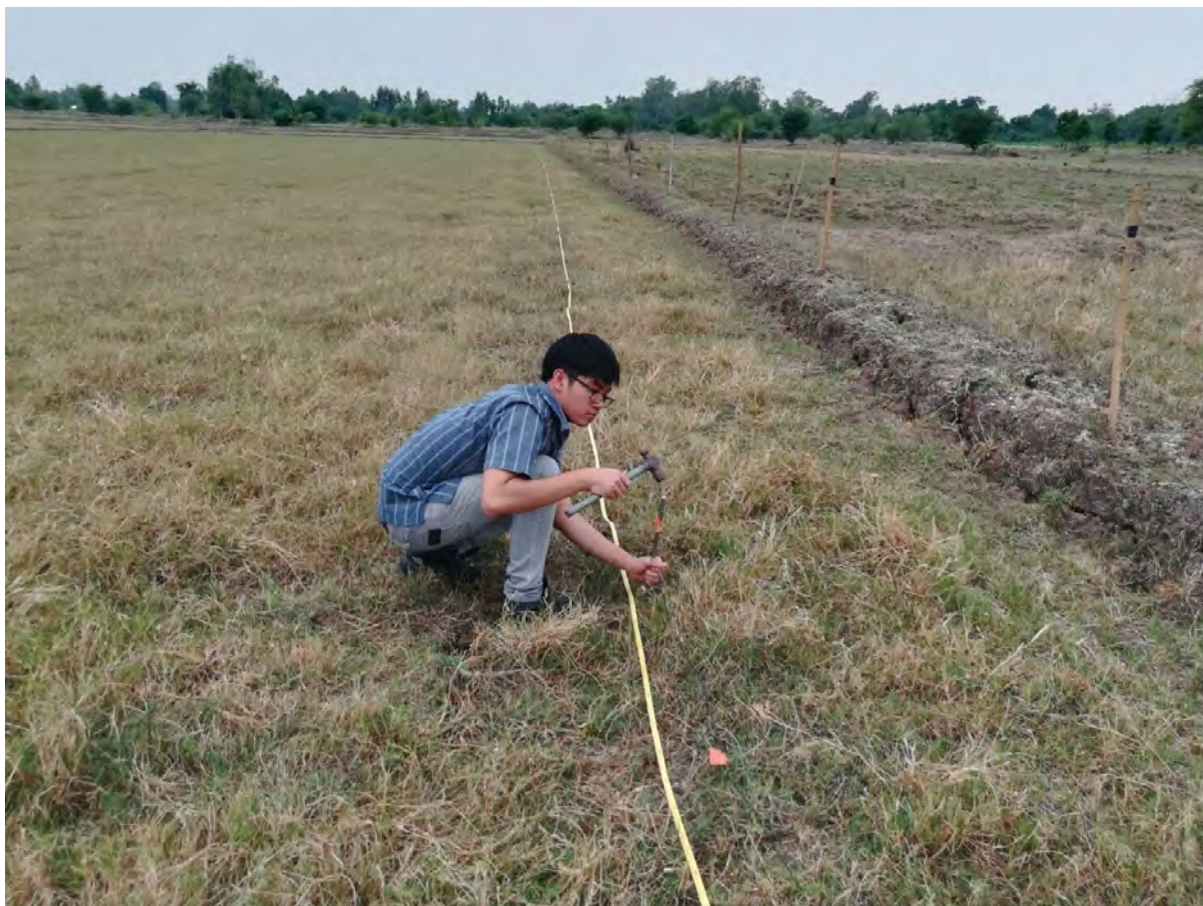
รูปที่ 4.11 ภาพการสำรวจธรณีฟิสิกส์ด้วยวิธีการวัดค่าความต้านทานไฟฟ้าจุดที่ 2
