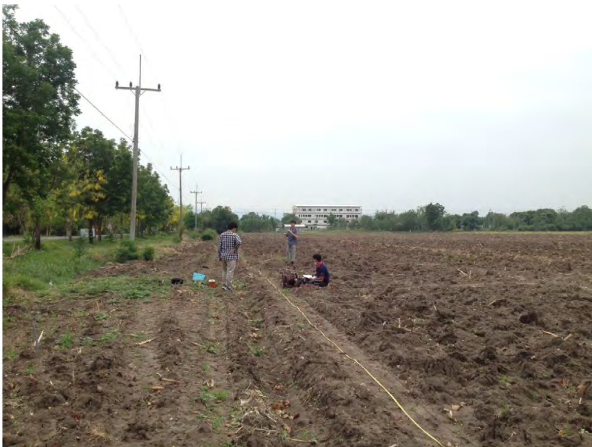
รูปที่ 4.9 ภาพการสำรวจธรณีฟิสิกส์ด้วยวิธีการวัดค่าความต้านทานไฟฟ้าจุดที่ 1
