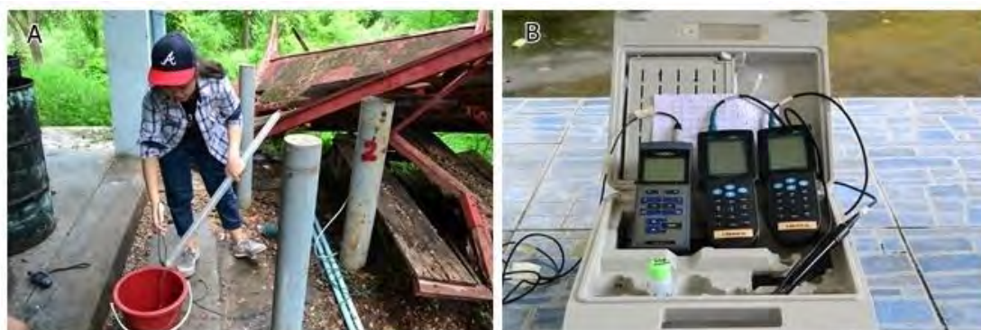
รูปที่ 2.1 A) การเก็บตัวอย่างน้ำบาดาล B) อุปกรณ์วัดค่าเคมีพื้นฐานของน้ำ
