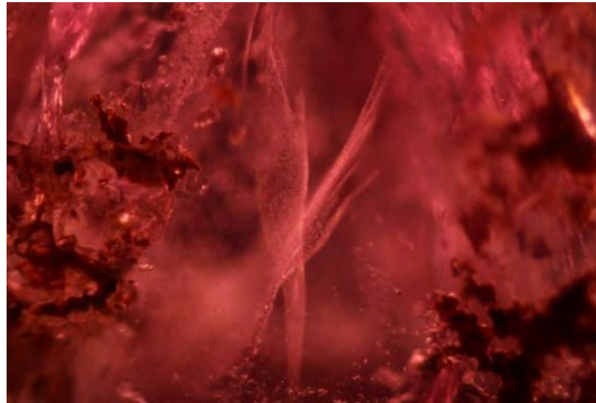
รูปที่ 4.36 รอยแตกผสานรอยนิ้วมือ กำลังขยาย x40 (KI_R10)
