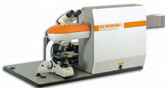
รูป 3.8 เครื่อง Laser Raman Spectroscopy รุ่น Model 1000, Renishaw จากสถาบันวิจัยและพัฒนาอัญมณีและเครื่องประดับแห่งชาติ (องค์การมหาชน)
