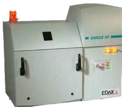
รูป 3.9 เครื่อง EDXRF รุ่น EAGLE III จากสถาบันวิจัยและพัฒนาอัญมณีและเครื่องประดับแห่งชาติ (องค์การมหาชน)
