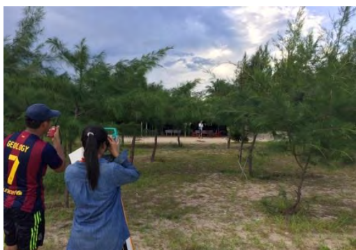
รูปที่ 3.6 แสดงการวัดระดับชายหาด (Beach profiling) ในแนวตั้งฉากกับชายหาดในช่วงน้ำลงต่ำสุด
