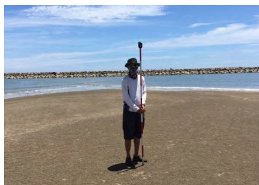
รูปที่ 3.6 แสดงการวัดระดับชายหาด (Beach profiling) ในแนวตั้งฉากกับชายหาดในช่วงน้ำลงต่ำสุด
