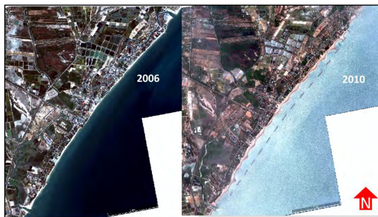
รูปที่ 5.3 แสดงการเปลี่ยนแปลงของหาดเจ้าสำราญในช่วงระหว่างสร้างเขื่อนกันคลื่น (ตั้งแต่ปี พ.ศ. 2549-2553)
