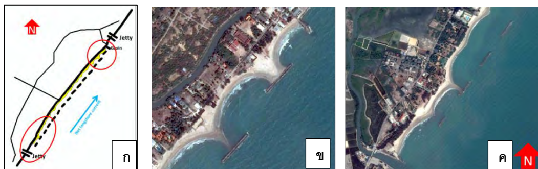
รูปที่ 5.4 แสดงการเปลี่ยนแปลงชายฝั่งหาดเจ้าสำราญหลังสร้างเขื่อนกันคลื่น (ปี พ.ศ. 2557)
