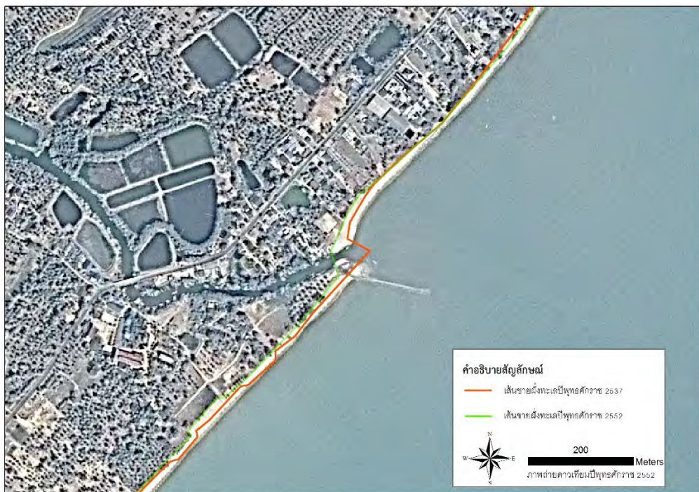
รูปที่ 4.24 การสร้าง Jetty บริเวณแม่น้ำกุยช่วงปี พศ. 2537-2552
