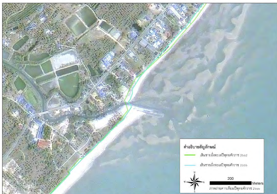
รูปที่ 4.28 การเปลี่ยนแปลงหลังจากการสร้าง jetty ช่วงปี พศ. 2552-2555
