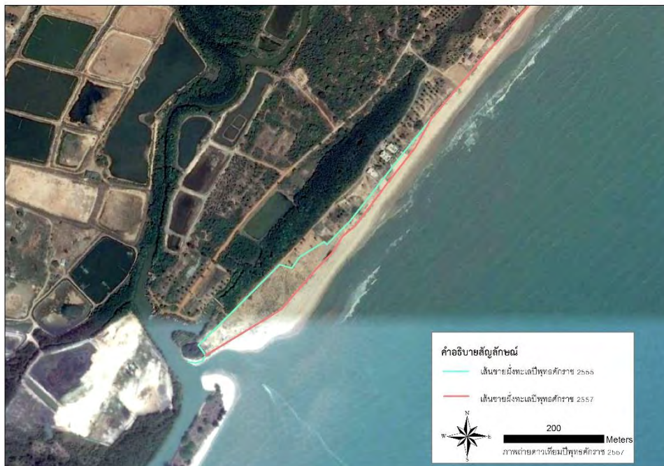
รูปที่ 4.31 การเปลี่ยนแปลงหลังจากการสร้าง jetty ช่วงปี พศ. 2555-2557
