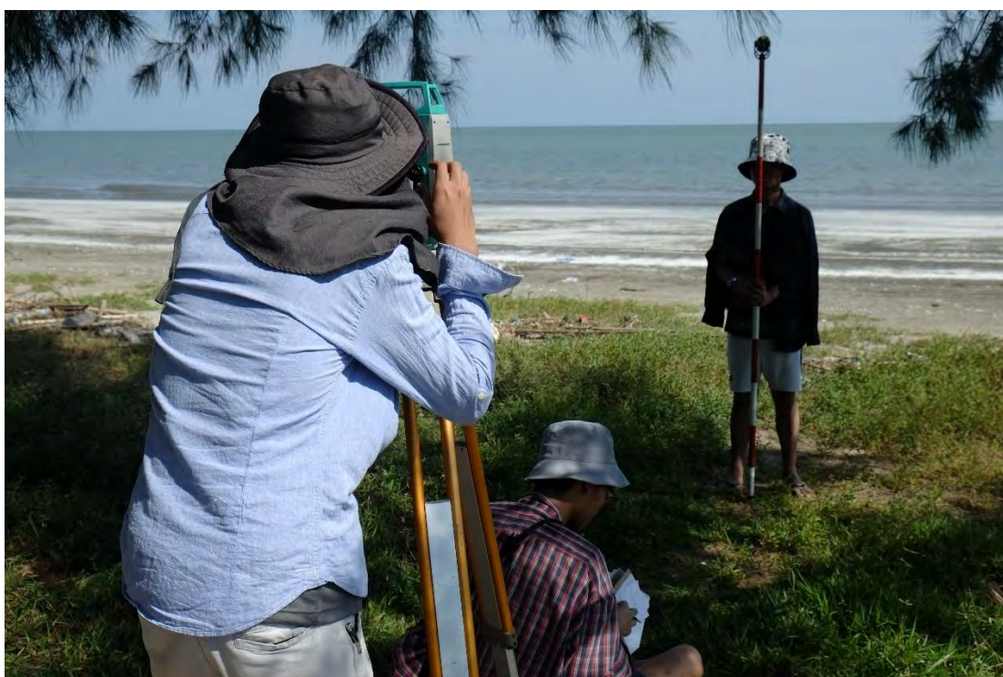
รูปที่ 3.16 การวัดความลาดชันของชายหาด
