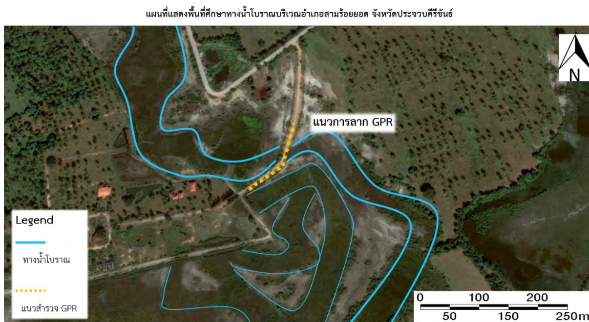
รูป 3.2 รูปแสดงแนวการสำรวจด้วยวิธี GPR โดยลากตัดทางน้ำโบราณ
