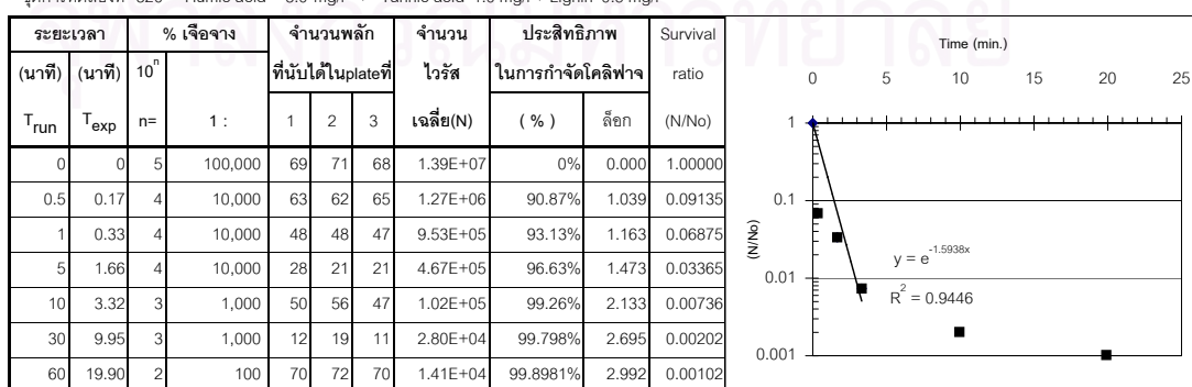
ชุดการทดลองที่ 320 Humic acid 3.0 mg/l + Tannic acid 1.0 mg/l + Lignin 0.5 mg/l
