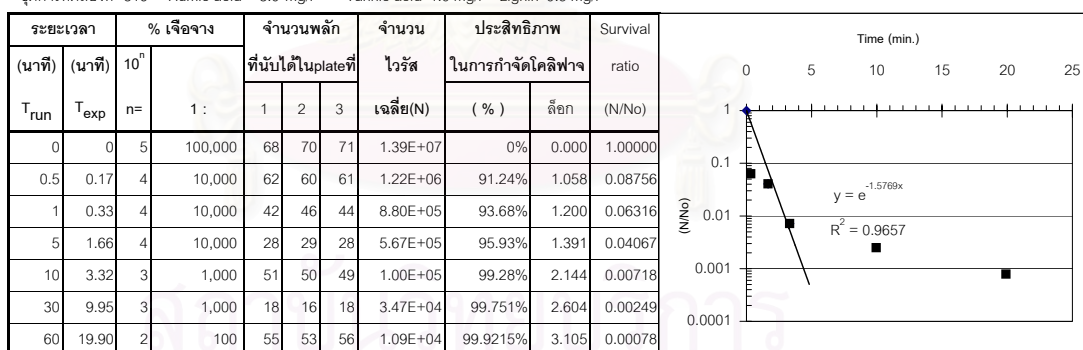
ชุดการทดลองที่ 319 Humic acid 3.0 mg/l + Tannic acid 1.0 mg/l + Lignin 0.5 mg/l
