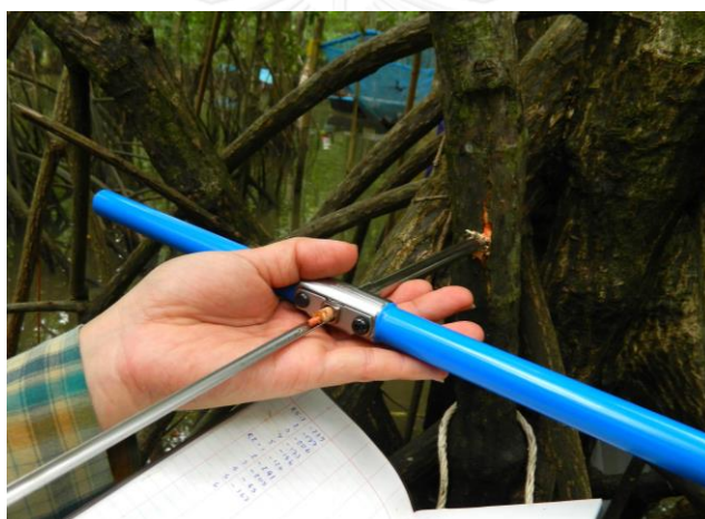
ภาพที่ 17 การหาความหนาแน่นเนื้อไม้ของ CWD โดยใช้ increment borer
