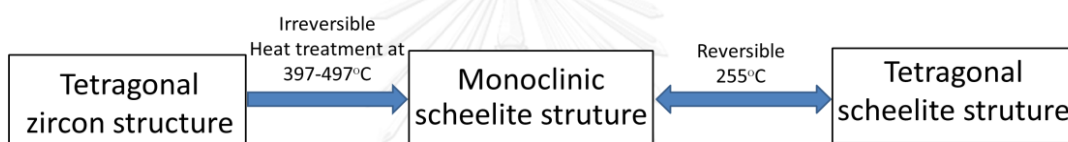
ภาพที่ 2.2 การเปลี่ยนแปลงโครงสร้างเฟสของบิส്മัทวานาเดต(7)
