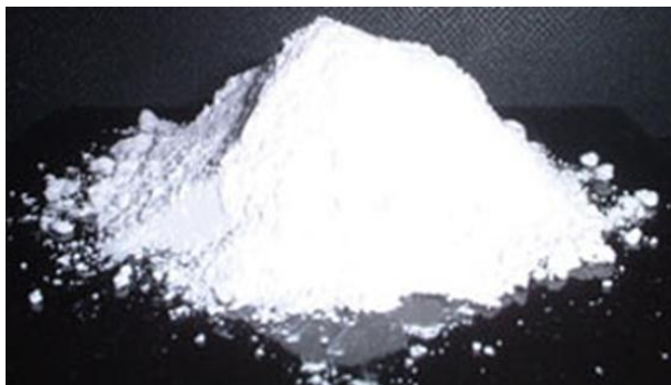
ภาพที่ 2.3 ลักษณะทางกายภาพของไทเทเนียมไดออกไซด์
