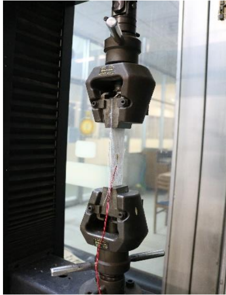
รูปที่ 3.3 การทดสอบความต้านทานแรงดึงแผ่นเส้นใยสังเคราะห์ชนิดถักทอ
