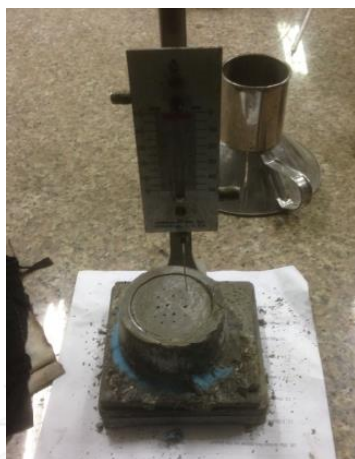
รูปที่ 3.11 การทดสอบระยะเวลาการก่อตัวของปูนซีเมนต์
