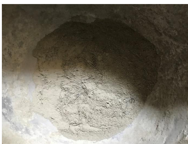
รูปที่ 3.9 การผสมระหว่างปูนซีเมนต์กับเส้นใยไฟเบอร์
