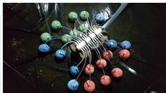
รูปที่ 3-3 หัวกระจายอากาศแบบหยาบหรือแบบแข็ง (Rigid diffuser)
