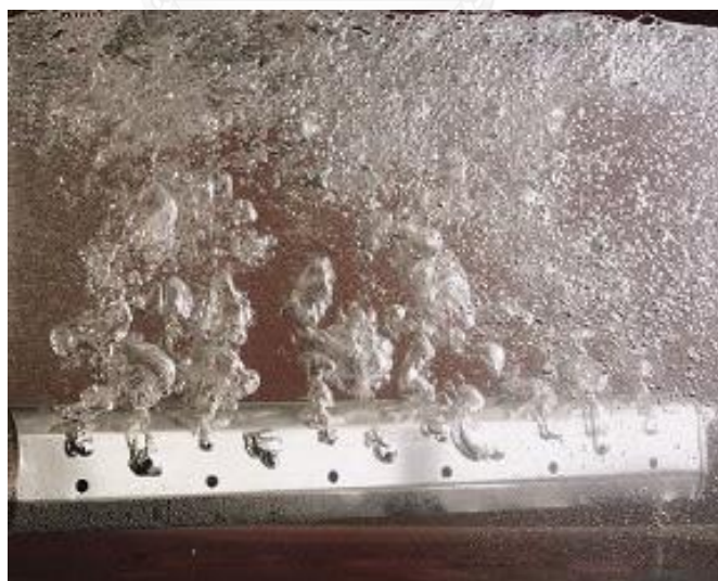
รูปที่ 2-5 อุปกรณ์กระจายอากาศชนิดฟองอากาศขนาดใหญ่
