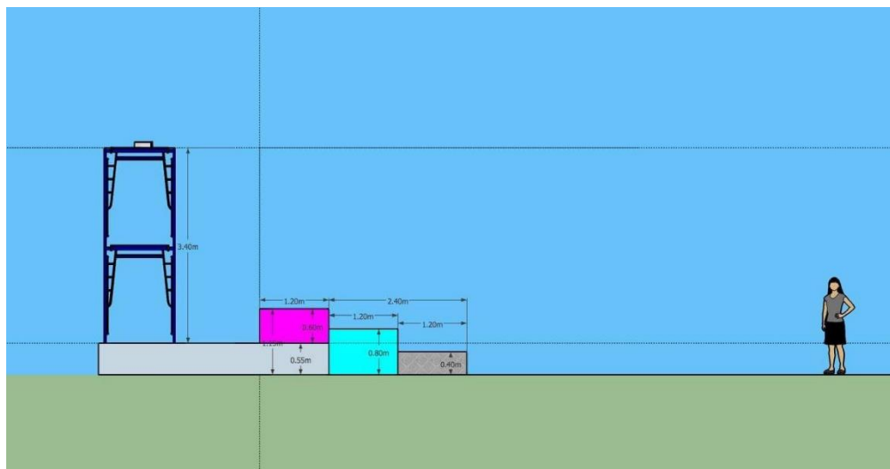
ภาพที่ 33 ภาพแสดงสัดส่วนและลักษณะการจัดที่นั่งผู้ชมชั่วคราวบนพื้นเวทีของบริเวณโถงชั้น 1 ตึก คณะศิลปกรรมศาสตร์ 2 และนั่งร้านที่จะติดตั้งเครื่องฉายไปยังเวที ที่มา: ผู้วิจัย
