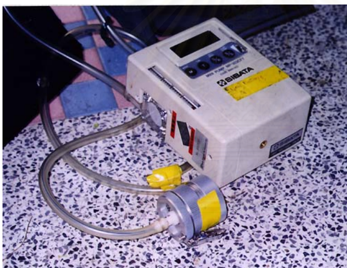
รูปที่ 3.4 ปัมดูดอากาศที่ติดหัวแยก cascade impactor ที่พร้อมใช้งาน
