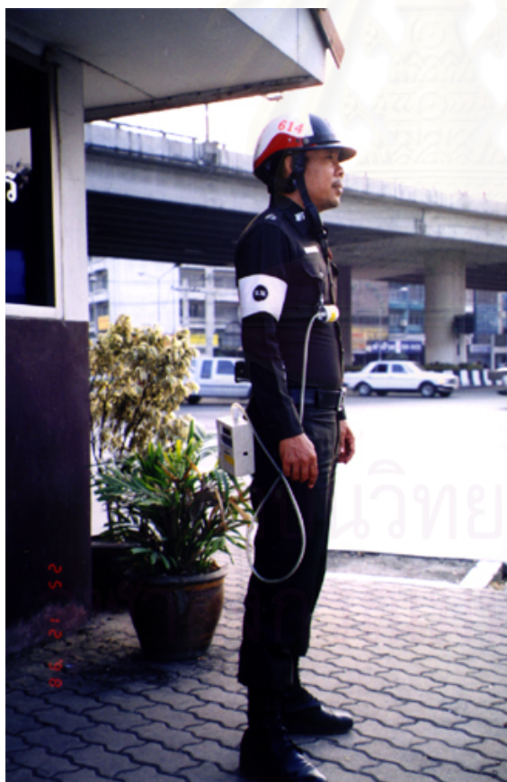
รูปที่ 3.6 การติดตั้งเครื่องมือเก็บฝุ่นละอองที่บุคคลได้รับสัมผัส
