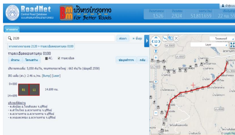
รูปที่ 3-2 ตัวอย่างการสืบค้นข้อมูลการจราจรรายวันเฉลี่ยตลอดปี (AADT) และจำนวนช่องทางการจราจร (ระบบสารสนเทศโครงข่ายและฐานข้อมูลกลางทางหลวง, 2555)
