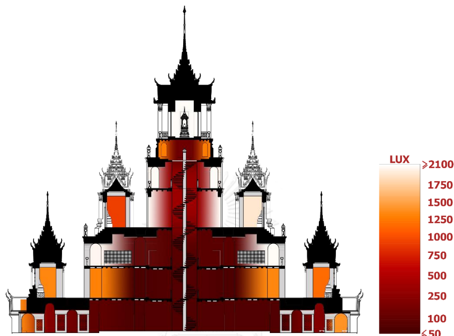
ภาพที่ 5.16 ภาพรูปตัดอาคาร แสดงตัวอย่างค่าความสว่างในแต่ละชั้น วันท้องฟ้าโปร่ง เวลา 10:00น.
