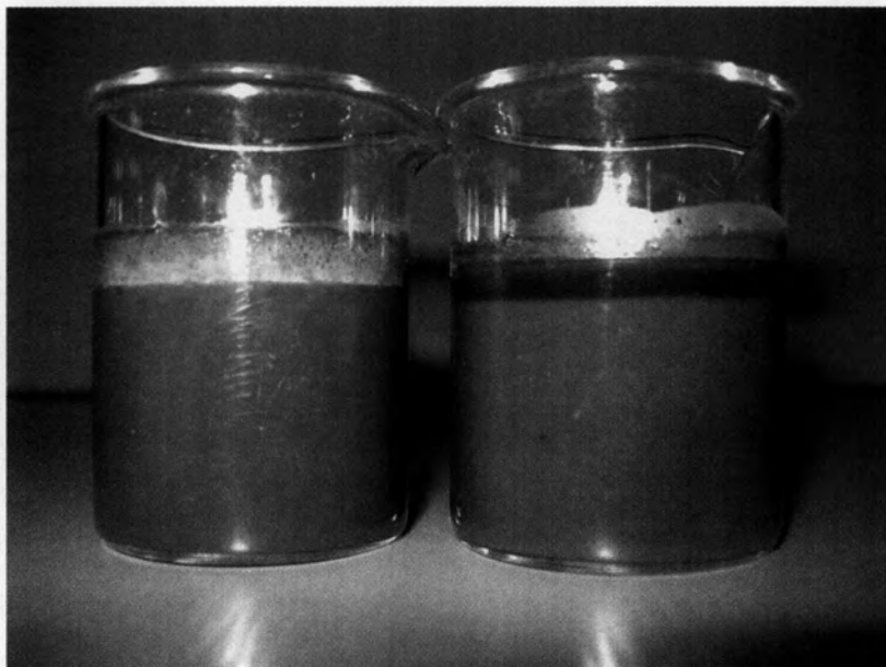
ภาพที่ 4.10 การแยกชั้นของตะกอนและของเหลว ที่ระยะเวลากักพักทางชลศาสตร์ 10 วัน (ซ้าย) น้ำเข้าระบบ (ขวา) น้ำออกจากระบบ
