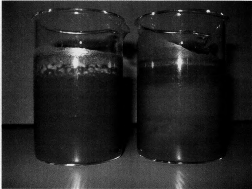
ภาพที่ 4.12 การแยกชั้นของตะกอนและของเหลว ที่ระยะเวลาพักทางชีวศาสตร์ 20 วัน (ซ้าย) น้ำเข้าระบบ (ขวา) น้ำออกจากระบบ
