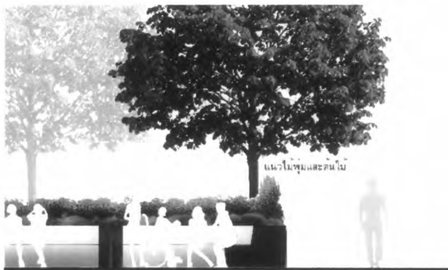
รูปที่ 8-44 แนวพุ่มไม้และต้นไม้ ปิดล้อมและพรางมุมมองจากภายนอกเพื่อสร้างความเป็นส่วนตัวให้ผู้ป่วยและญาติ
