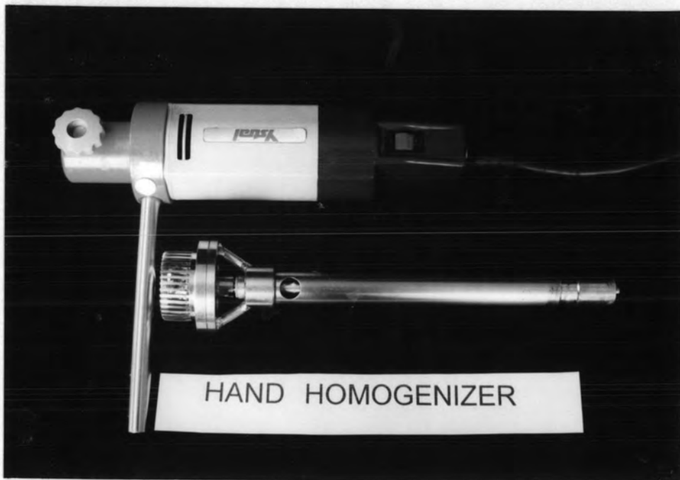
รูป ง.8 เครื่องโฮโมจีไนเซอร์ (hand homogenizer, series X10/20) หัวผสม (mixing head, 3923 14 ) และแกนหัวผสม (shaft, 20/T)
