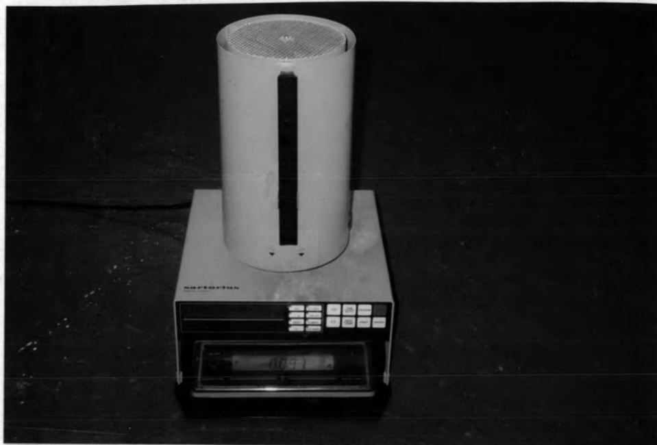
รูป ง.1 ชุดอุปกรณ์วิเคราะห์ความชื้น (TMC0, 1L)
