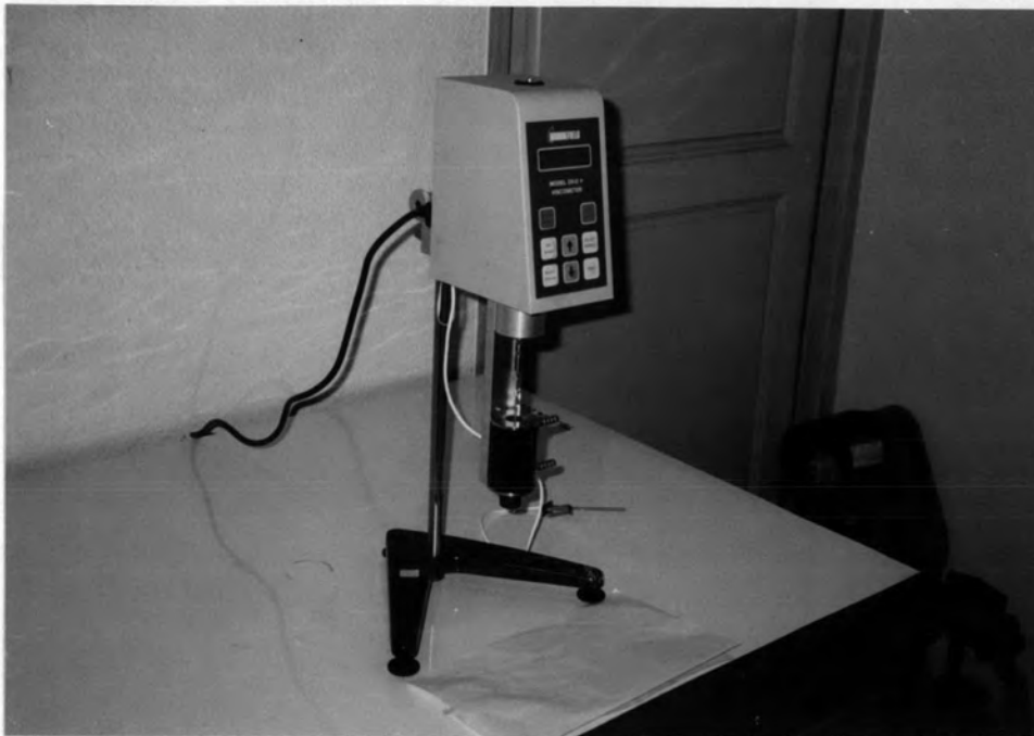
รูป ง.5 เครื่องวัดความหนืด (Brookfield digital viscometer, DV-II+) หัวเข็มรหัส 27 วัดความหนืดผลิตภัณฑ์มาของเนส
