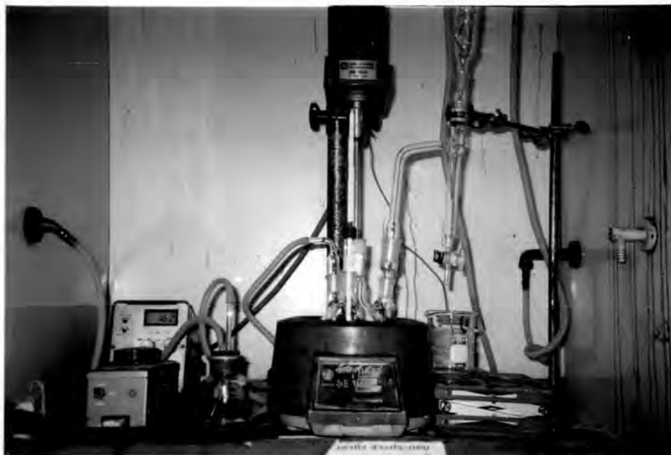
รูปที่ 3.2 อุปกรณ์การสังเคราะห์พอลิเอสเตอร์เรซินชนิดไม่อิมตัว
