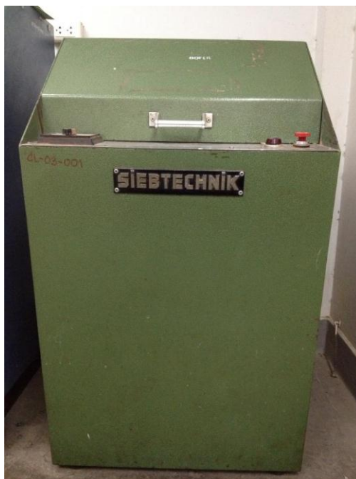
รูปที่ 3.3 เครื่องบดตัวอย่างดิสก์มิลล์ (Disc Mill) ยี่ห้อ Siebtechnik รุ่น TS 250
