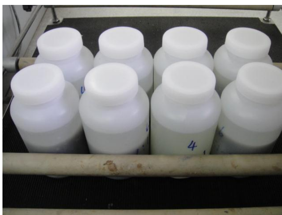
รูปที่ 3.5 ตัวอย่างเข้าเผาพลอยทับทิมที่นำไปเขย่าด้วยเครื่องหมุน
