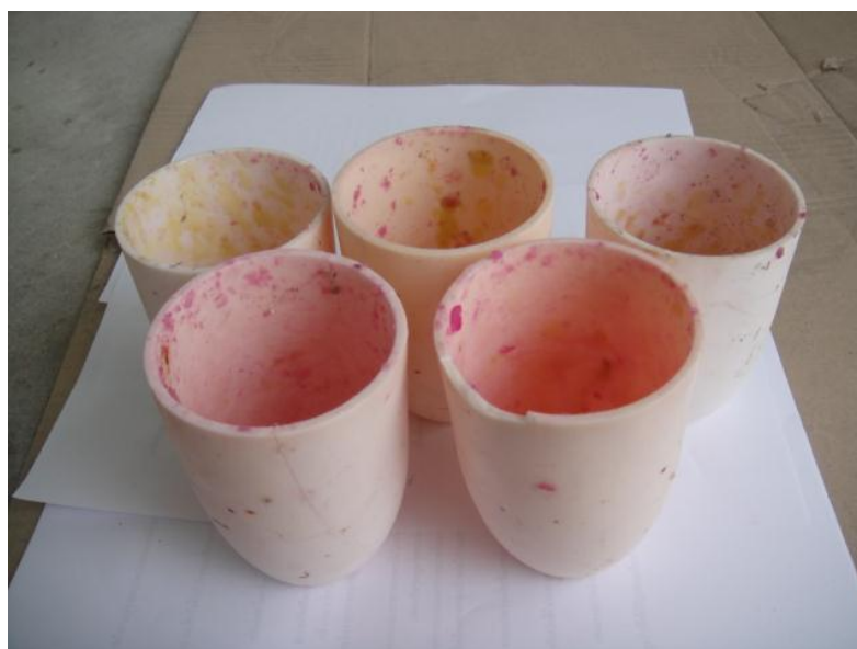
รูปที่ 3.2 ตัวอย่างเข้าเผาพลอยที่เก็บมาจาก 1 โรงงาน
