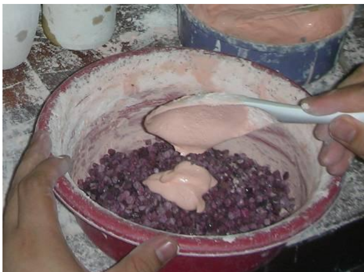
รูปที่ 2.2 ผสมพลอยกับสารเคมีประเภทแก้วตะกั่ว
