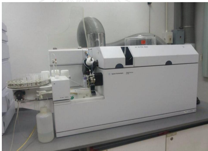
รูปที่ 3-3 เครื่อง Inductively coupled plasma mass spectrometry (ICP-MS)
