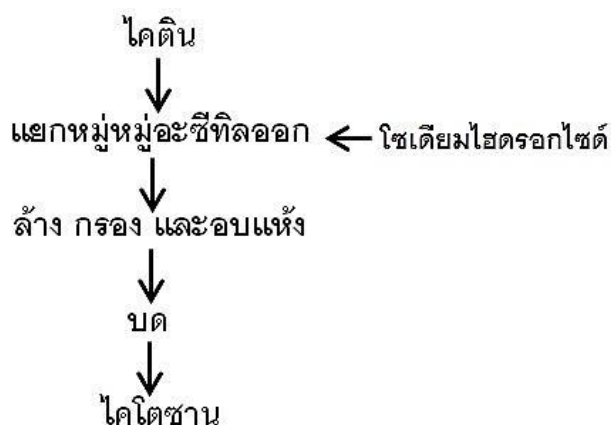
ภาพที่ 2.16 ขั้นตอนทั่วไปของกระบวนการเตรียมไคโตซาน
