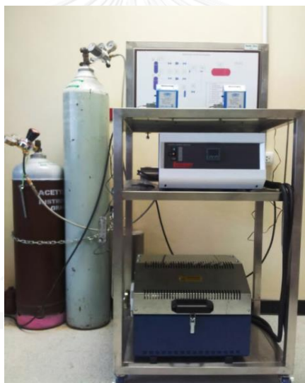
ภาพที่ 3.2 เครื่องตกเคลือบด้วยไอเคมี (Chemical Vapor Deposition, CVD)
