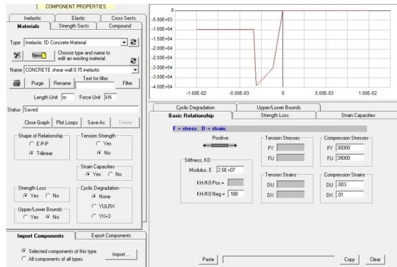
รูปที่ 3.7 คุณสมบัติคอนกรีตของกำแพงรับแรงเฉือนในโปรแกรม PERFORM-3D
