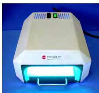
รูปที่ 29 แม่แบบสำหรับเตรียมชิ้นตัวอย่างรูปเหรียญ และ ตู้บ่มด้วยแสง
