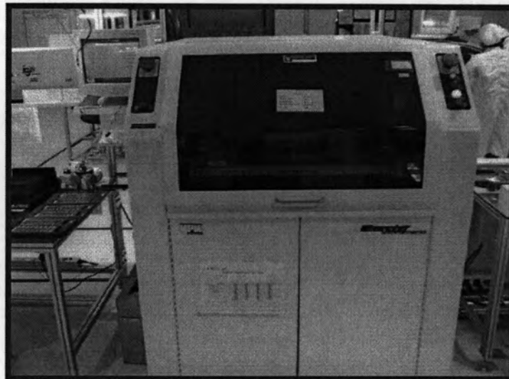
รูปที่ 3.3 แสดงกระบวนการทำ Top Side Solder Paste Printing
