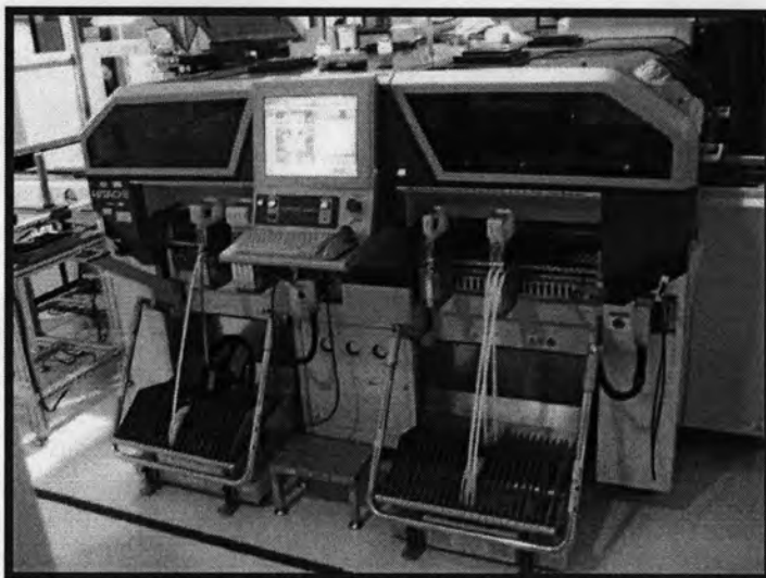
รูปที่ 3.4 แสดงกระบวนการทำ Top Side Component Placement
