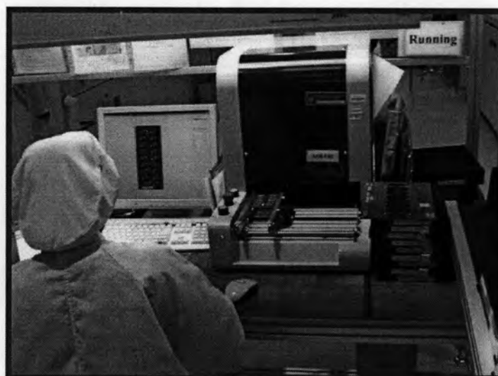
รูปที่ 3.9 แสดงกระบวนการตรวจสอบด้วยเครื่อง AOI
