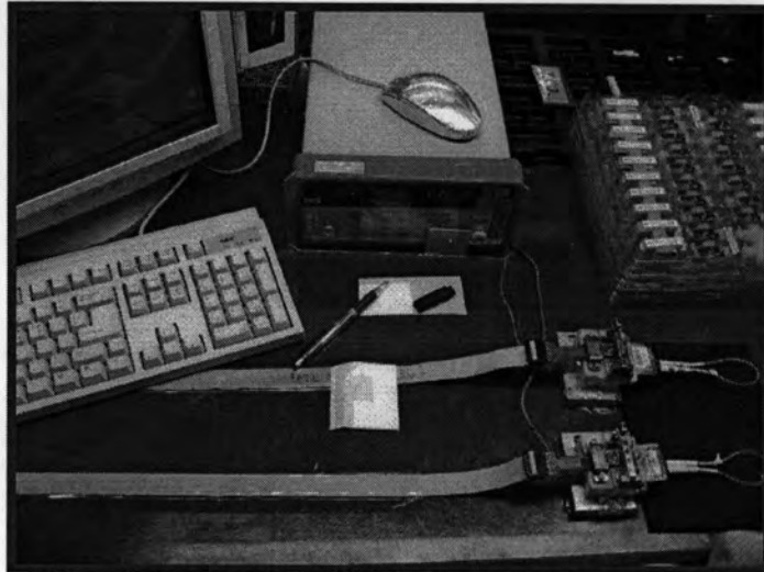
รูปที่ 3.12 แสดงกระบวนการตรวจสอบทางไฟฟ้าด้วยเครื่อง ICT
