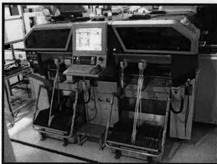
รูปที่ 3.7 แสดงกระบวนการทำ Bottom Side Component Placement
