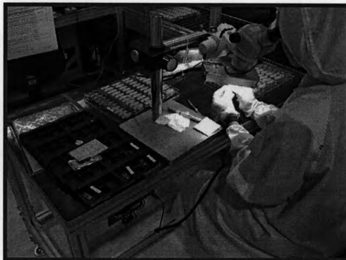
รูปที่ 3.13 แสดงกระบวนการตรวจสอบคุณภาพด้วยพนักงานฝ่ายผลิต
