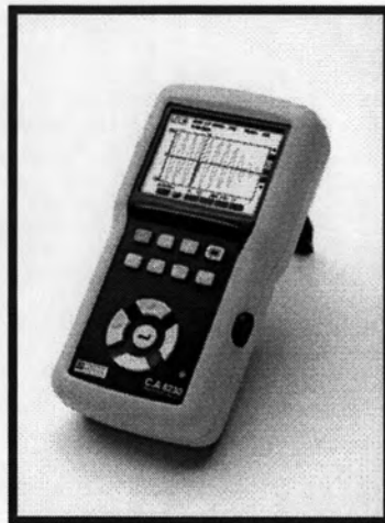
รูปที่ 3.17 แสดงเครื่องวัดและบันทึกค่าทางไฟฟ้า
