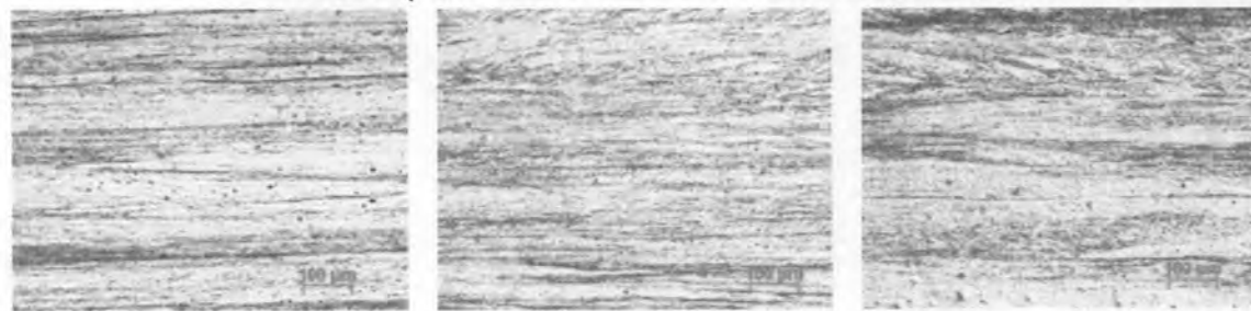
โลหะผสมชุดที่ 8 : 0.04%Si-1.66%Zn -3.77%Cu-balance of Ag
