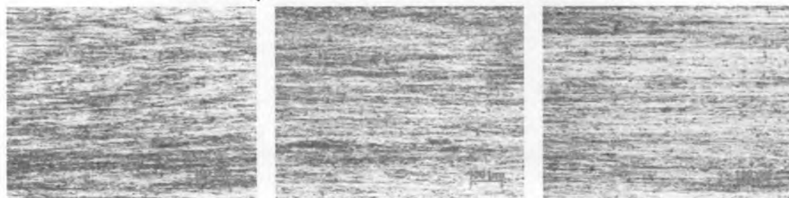
โลหะผสมชุดที่ 7 : 0.02%Si-4.11%Zn -2.01%Cu-balance of Ag
