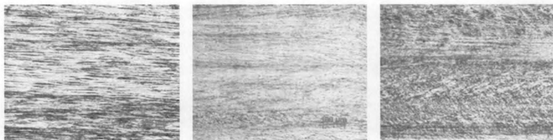
โลหะผสมชุดที่ 10 : 0.036%Si-3.23%Zn -2.30%Cu-balance of Ag
