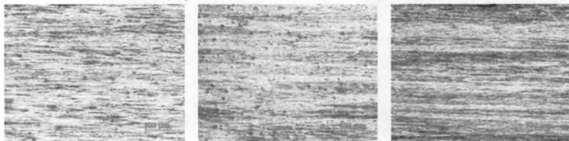
โลหะผสมชุดที่ 6 : 0.02%Si-2.93%Zn -3.13%Cu-balance of Ag
