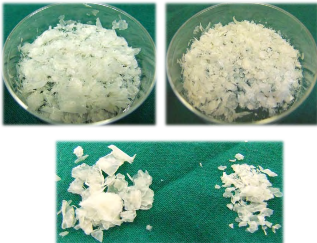
ภาพที่ 13 แสดงลักษณะเกล็ดไคติน (ซ้ายบน) เกล็ดไคตินภายหลังการบดด้วยเครื่องบดชนิดบอลมิลล์ (ขวาบน) และการเปรียบเทียบขนาดเกล็ดก่อนและหลังการบด (ล่าง)
