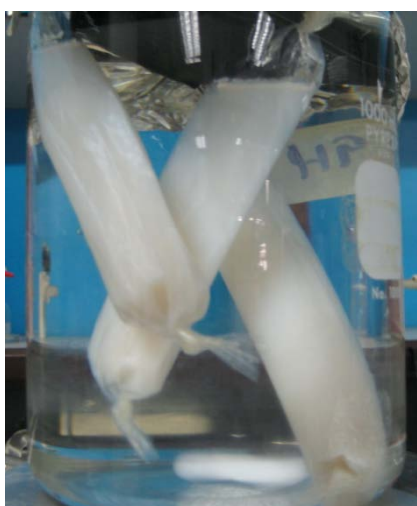
ภาพที่ 28 แสดงสารคอลลอยด์ไคตินวีลเกอร์ (ซ้าย) และสารคอลลอยด์ไคโตซานวีลเกอร์ (ขวา) ภายในถุงเยื่อแผ่นกรอง
