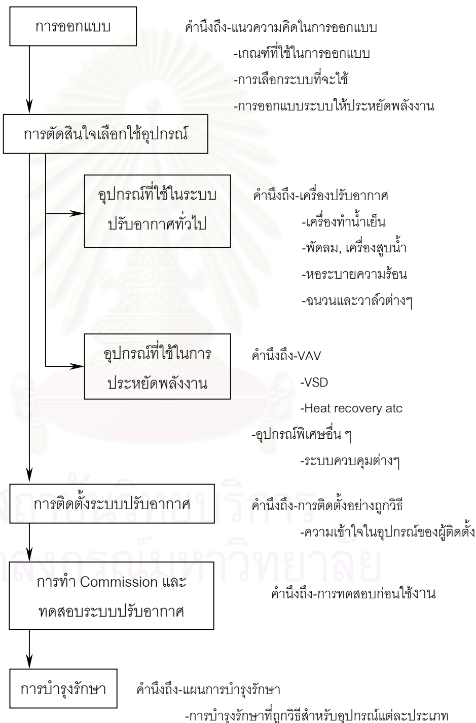
รูปที่ 3.8 กระบวนการในการอนุรักษ์พลังงานในระบบปรับอากาศ
