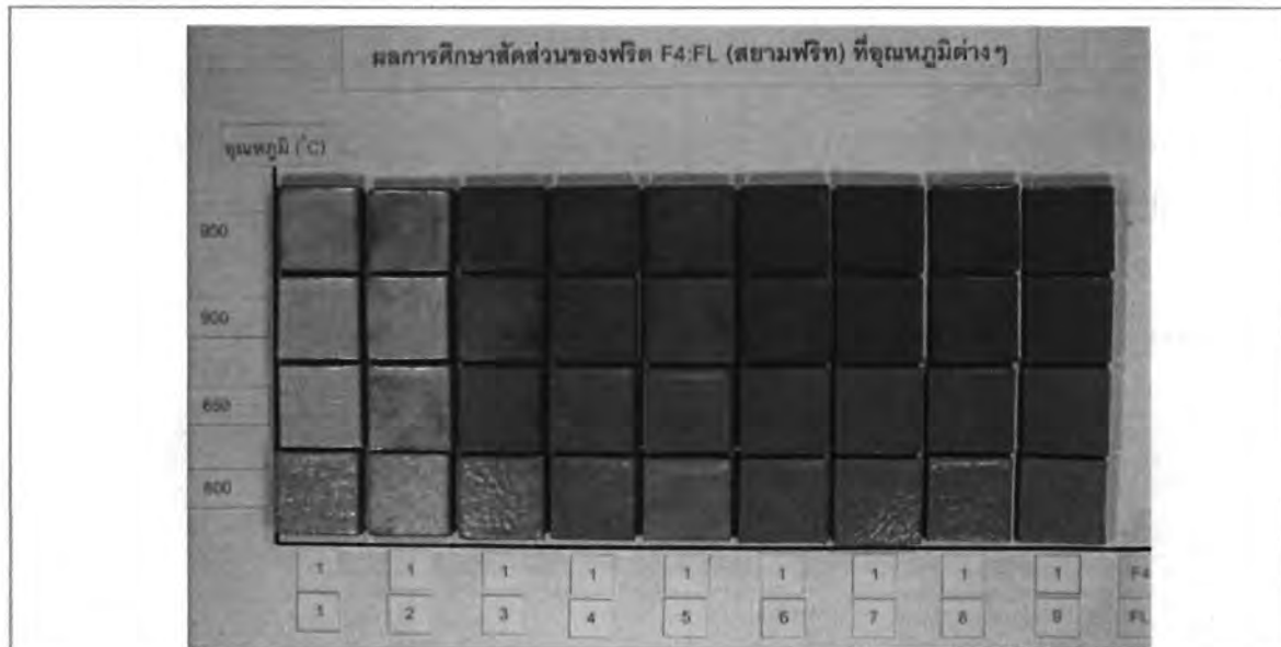
รูปที่ 6.3 ชิ้นงานเคลือบ F4 ผสมกับ FL ในสัดส่วนต่างๆ ที่อุณหภูมิ 800 – 950 องศาเซลเซียส
