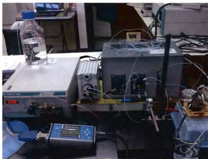
รูปที่ 3.4 การสกัดด้วยเฟสของแข็งแบบอัตโนมัติ โดยใช้ระบบซีเควินเซียลอินเจกชันร่วมกับเทคนิคแอมเพอโรเมตรี
