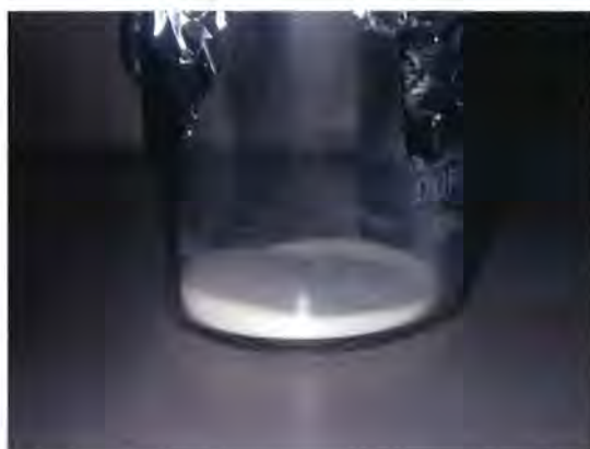
รูปที่ 3.1 อนุภาคของแข็งชนิด Oasis HLB จากการสกัดด้วยเฟสของแข็ง
