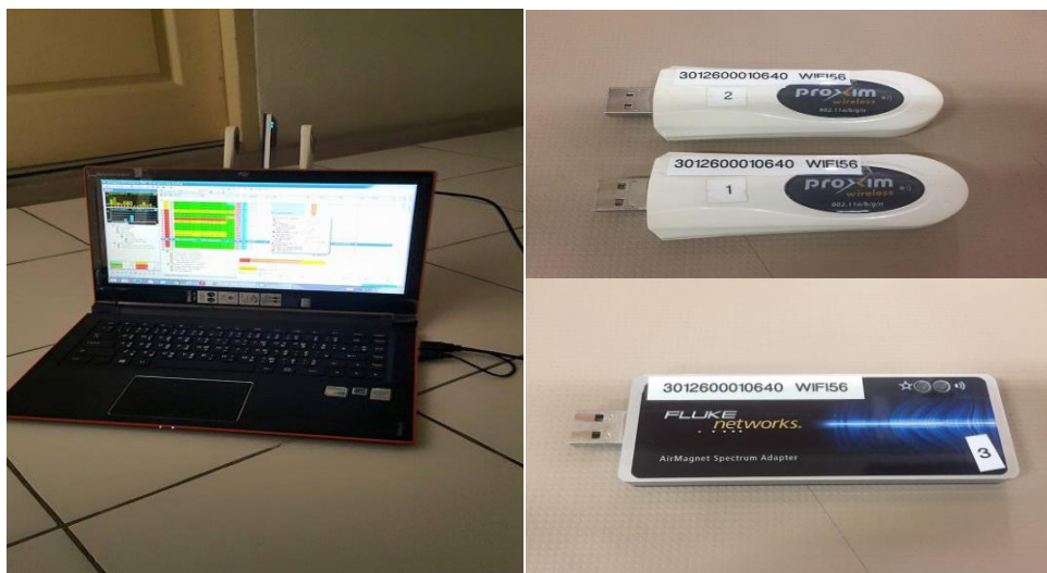
รูปที่ 2.1: อุปกรณ์ที่ใช้ในการทดสอบสัญญาณแลนไร้สาย
