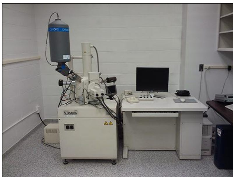
รูปที่ 3.13 กล้องจุลทรรศน์อิเล็กตรอนแบบส่องกราด ยี่ห้อ Hitachi รุ่น S-3500N
