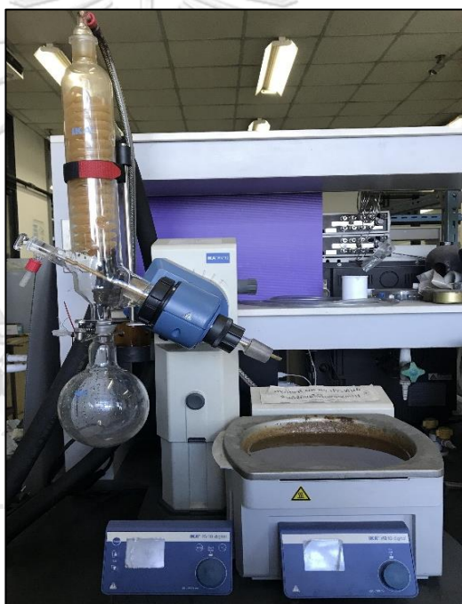
รูปที่ 3.4 เครื่องกลั่นระเหยแบบหมุน (rotary evaporation)
