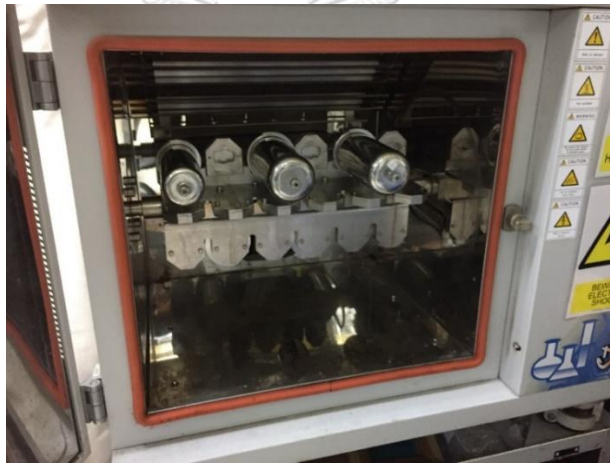
รูปที่ 3.8 เครื่องทดสอบความคงทนของสีต่อการซัก DaeLim Starlet II DLS-8080
