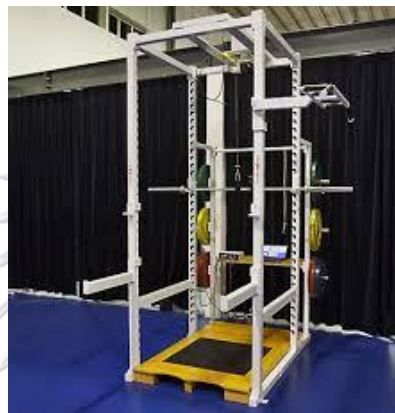
รูปที่ 2 เครื่อง FT 700 power system
