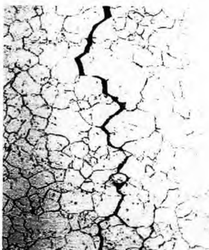
รูป ก : การกัดกร่อนเชิงความเค้นแบบตามขอบเกรนที่กำลังขยาย 500 เท่า
