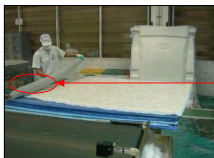
รูปที่ 3.10 การประกบ Covering Nonwoven ลงบนแผ่นโพลียูรีเทนโฟม
