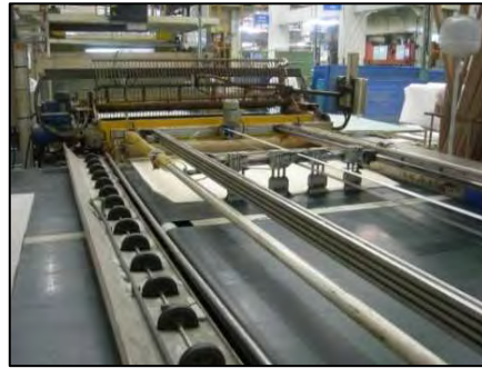
รูปที่ 3.6 การรีดกาวลงบนแผ่นโฟลียูรีเทนโฟม
