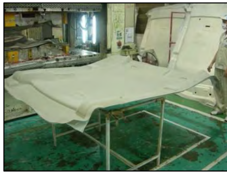
รูปที่ 3.12 ชิ้นงานผ้าหลังคาที่ผ่านกระบวนการอัดขึ้นรูป
