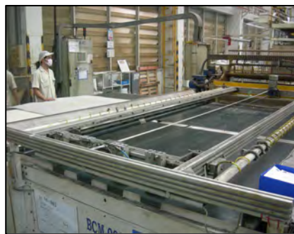
รูปที่ 3.5 การป้อนโฟมผ่านเครื่องจักร
