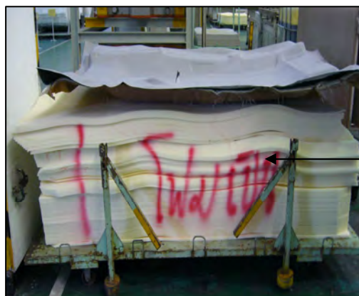
รูปที่ 3.17 ลักษณะข้อบกพร่องโฟมนิ่ม
