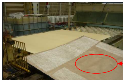
รูปที่ 3.7 การจัดวางแผ่นกระดาษย่นกับแผ่นไฟเบอร์กลาส
