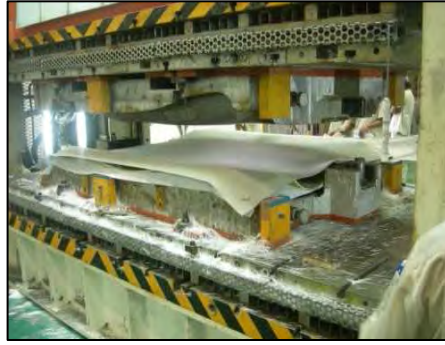
รูปที่ 3.11 การอัดขึ้นรูปชิ้นงานผ้าหลังคา
