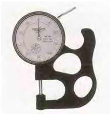
รูปที่ 4.3 เครื่องมือวัดความหนาชิ้นงานผ้าหลังคา
