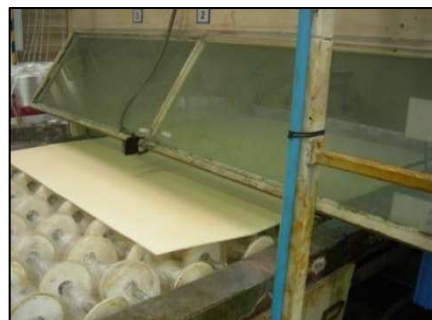
รูปที่ 3.8 การฉีดพ่นละอองน้ำบนแผ่นโฟลียูรีเทนโฟม
