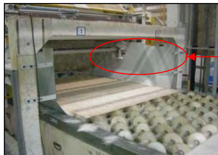
รูปที่ 3.9 การโปรยเส้นใยไฟเบอร์ลงบนแผ่นโพลียูรีเทนโฟม
