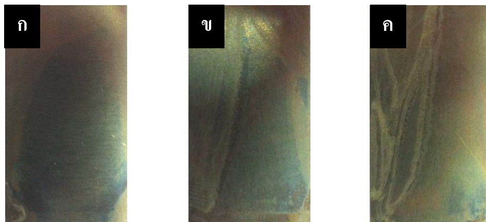
รูปที่ 4.8 ภาพถ่ายชิ้นงานที่เคลือบผิวด้วยโซเดียมไฮดรอกไซด์ที่ความเข้มข้น 0.025 M ที่จำนวนชั้นต่างๆกัน (ก) 1 ชั่วโมง (ข) 2 ชั่วโมง (ค) 3 ชั่วโมง
