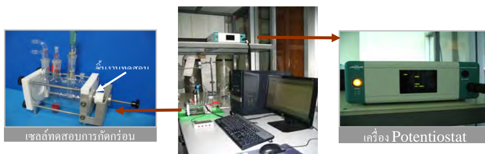
รูปที่ 3.1 ชุดอุปกรณ์ทดสอบการกัดกร่อนด้วยเครื่องโพเทนชิออสแตท
