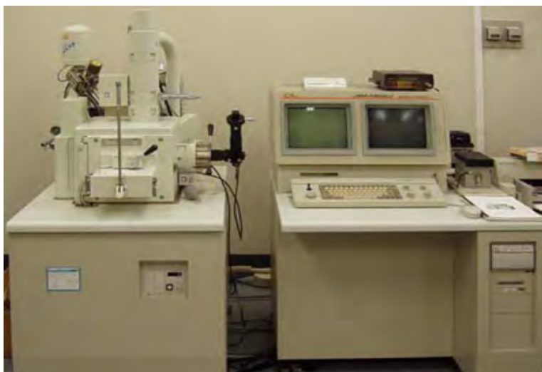
รูปที่ 3.6 กล้องจุลทรรศน์อิเล็กตรอนแบบส่องกราด รุ่น JEOL JSM-5800LV
