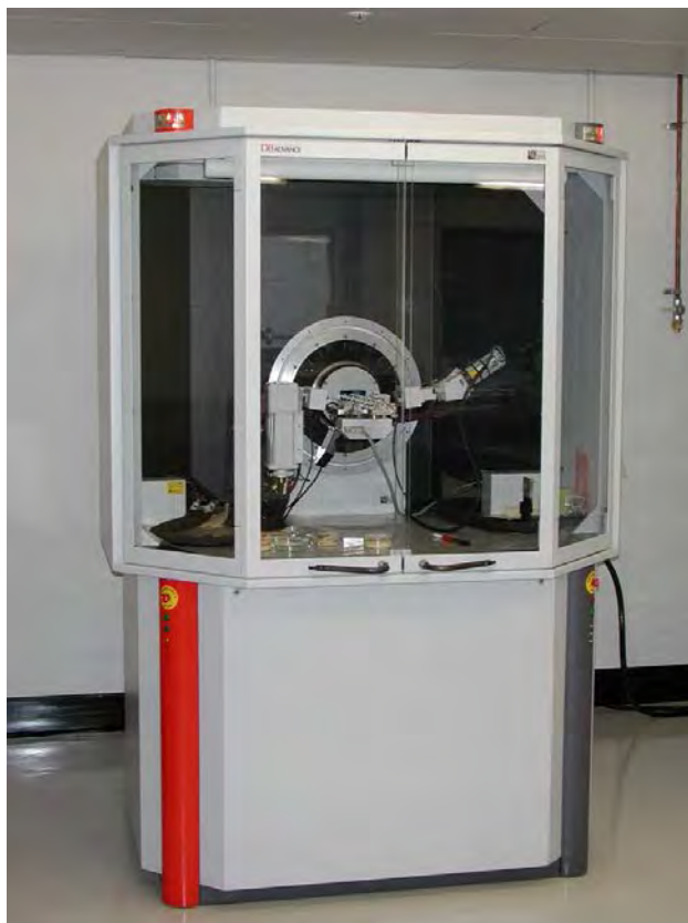
รูปที่ 3.7 เครื่องเอกซเรย์ดิฟแฟรกโทมิเตอร์ ของ Bruker AXS Model D8
