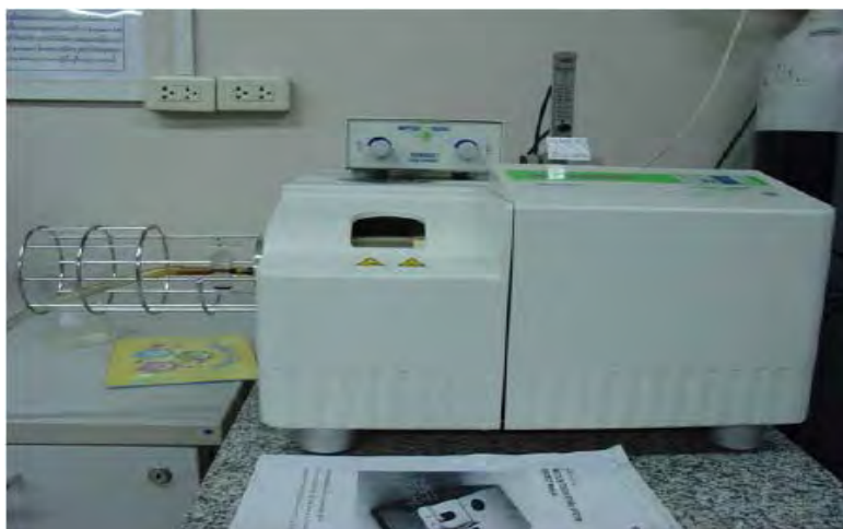
รูปที่ 3.5 เทอร์มอกราวิเมทริกแอนาไลเซอร์ ของ METTLER TOLEDO รุ่น TGA/SDTA 851°
