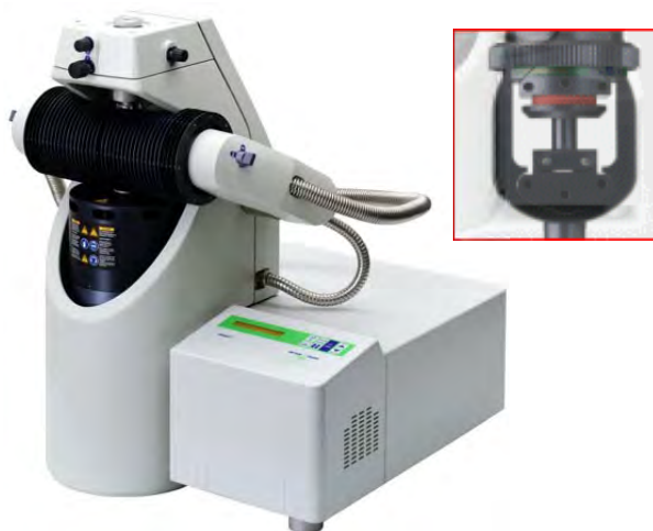
รูปที่ 3.8 เครื่องไดนามิคเมคคานิคอลแอนาไลซิส รุ่น DMA/SDTA861° ของ METTLER TOLEDO
