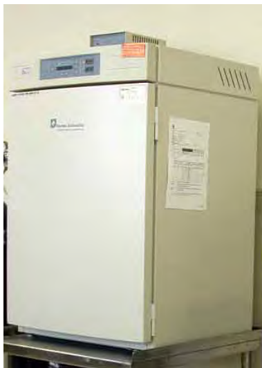
รูปที่ 3.17 ตู้ควบคุมอุณหภูมิและก๊าซเฉพาะอย่าง (CO 2 incubator) Heraeus รุ่น Hera cell
