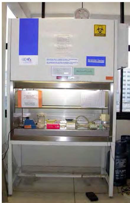
รูปที่ 3.18 ตู้ปฏิบัติการปลอดเชื้อ (Laminar air flow) Biohazard Cabinet class II รุ่น BH2000
