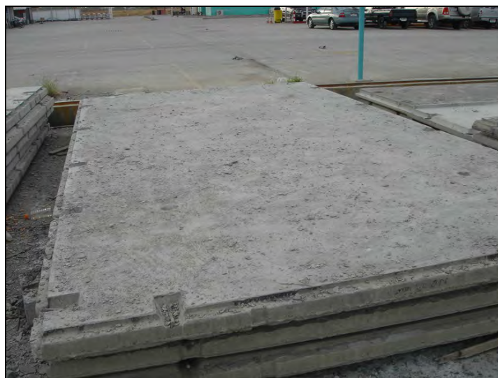
รูปที่ 4.13 ลักษณะผิวหน้าของชิ้นงานแบบหยาบ
