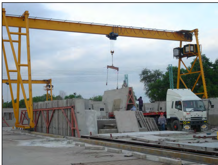
รูปที่ 4.19 การยกชิ้นงานขึ้นบนรถบรรทุกเพื่อจัดส่งไปยังหน่วยงานติดตั้งชิ้นงาน
